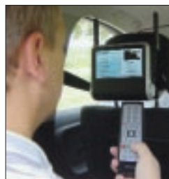
Der Karlsruher Spezialist für Navigation, Multimedia und Infotainment im Auto, Harman/Becker, präsentierte ebenfalls einen DVB-T Receiver fürs Auto. Das Gerät ist durch seine kompakte Bauweise und die zum Lieferumfang gehörende Docking-Station bestens für den Einsatz im Auto vorbereitet. Ähnlich einem Laptop lässt sich der Empfänger problemlos aus der Docking-Station entnehmen und als „stand-alone“-Version verwenden.
